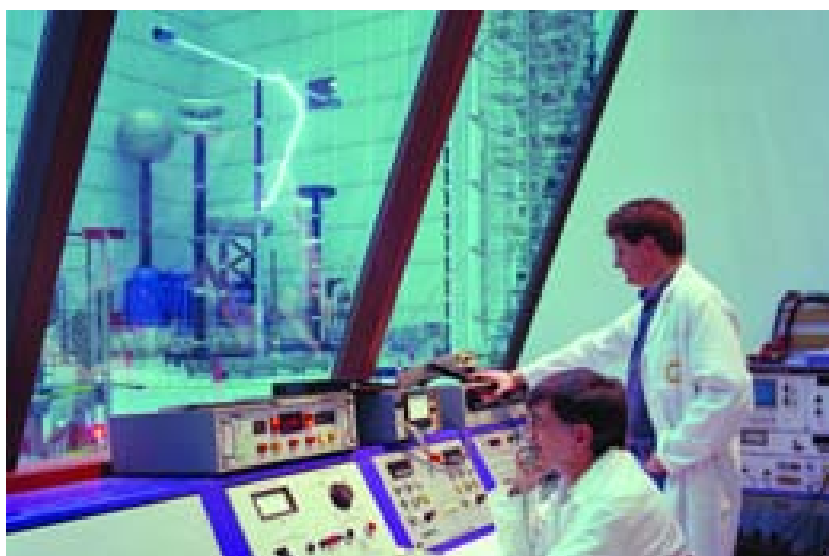
Dans les vastes installations de l'Institut de recherche d'Hydro-Québec, à Varennes, il est possible de reproduire la foudre lors d'essais à haute tension.
